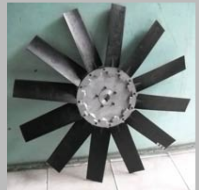
Cooling Tower Fan
